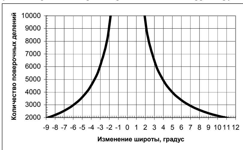
Рисунок 2 – Зависимость количества поверочных делений весов среднего класса точности, не требующих переюстировки, от изменения широты при неизменной высоте над уровнем моря.
