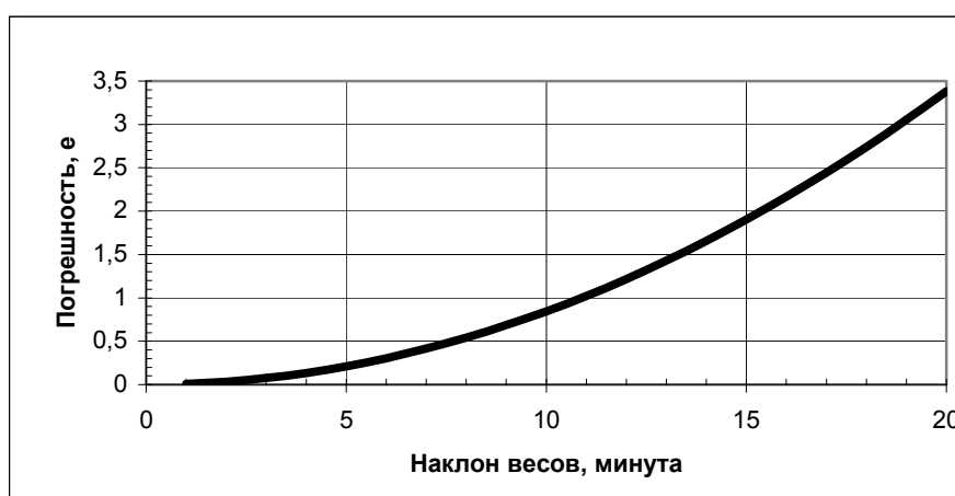
Рисунок 3 – Зависимость погрешности весов при нагрузке равной 200000е, обусловленной наклоном, от угла наклона весов.
